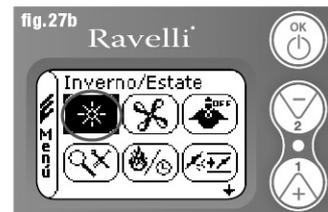
Dallo stato di fig. 15-A (par.7.2) per accedere al MENU UTENTE premere il pulsante OK per 2 volte. Per accedere alla MODALITÀ STAGIONE premere per 6 volte il tasto 2. Abilitare o disabilitare la funzione utilizzando il tasto OK. Per tornare alla schermata iniziale premere contemporaneamente i tasti 1 e 2. In alternativa è possibile uscire a step dai menu tenendo premuto ogni volta il pulsante OK.
