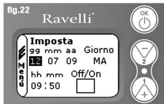
Per tornare alla schermata iniziale premere contemporaneamente i tasti 1 e 2. In alternativa è possibile uscire a step dai menu tenendo premuto ogni volta il pulsante OK.
