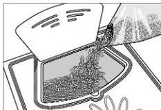
**Si raccomanda di non appoggiare il sacco di pellet sulle ceramiche durante l'operazione di carico. Si raccomanda inoltre di mantenere ad adeguata distanza dalla stufa il pellet e/o altri materiali infiammabili.**
