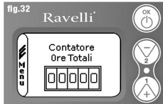
Sarà cura del tecnico provvedere ad azzerare tali numeri in fase di prima accensione. Questo non indica che la stufa abbia già lavorato per tutte quelle ore, è solamente un'impostazione data dalla programmazione durante i test di primo collaudo in Ravelli, prima che le stufe vengano imballate e spedite. Questo menù è utilizzato dal C.A.T. (Centro Assistenza Tecnica) per valutare le ore
