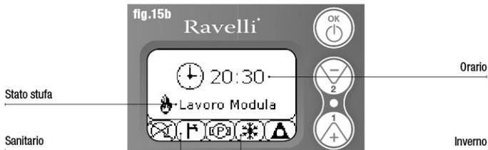
**N.B.:** Il simbolo del RISCALDAMENTO/SANITARIO indica la posizione della valvola a tre vie (solo su modelli che prevedono il kit sanitario incorporato nella termostufa mod. HRV160 - HR200). **N.B.2:** Il simbolo del pulitore è attivo solo su modelli di stufe aventi il sistema di pulitore automatico.
