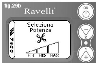
Con la ventilazione attiva è possibile impostare la potenza della ventola scambiatore ambiente, inoltre è possibile anche la disattivazione della stessa portando la barra di velocità a 0. Con il tasto 1 e 2 impostare la potenza della ventola fra le 4 proposte:
