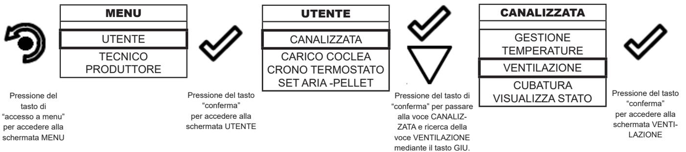
Una volta effettuato l'accesso alla voce ventilazione, si avrà la seguente schermata: nella riga superiore del display viene mostrata la potenza della ventilazione frontale, la parte inferiore del display mostra la ripartizione dell'aria calda tra le canalizzazioni.
