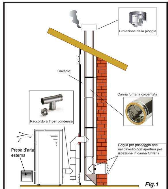
All'uscita della stufa non montare una curva a 90°, in quanto la cenere potrebbe ostruire in poco tempo il passaggio dei fumi, causando problemi di tiraggio della stufa (vedi Fig. 2).
