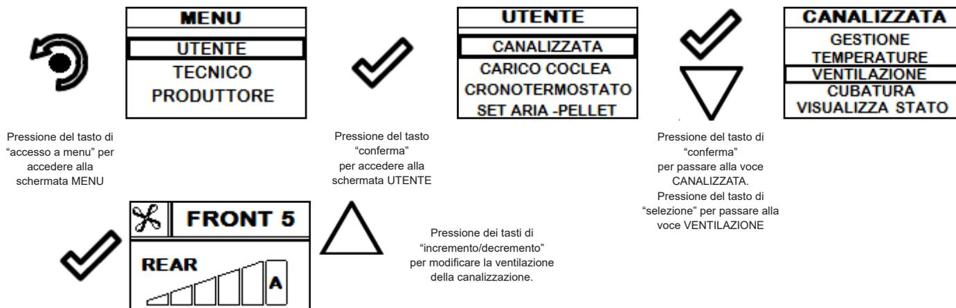
La parte superiore del display mostra la velocità della ventilazione frontale, che è legata alla potenza della stufa (es.: Front 5), la parte inferiore del display mostra la potenza della canalizzazione, la quale può essere modificata con i tasti di "incremento/decremento". Il valore impostabile va da 0 (canalizzazione spenta) a 5. Con impostazione su A (auto) la potenza della ventola della canalizzazione segue la potenza della stufa.
